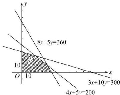
(2) 设利润为  $z$  万元, 则目标函数  $z = 2x + 3y$ , 这是斜率为  $-\frac{2}{3}$ , 随  $z$  变化的一族平行直线.  $\frac{z}{3}$  为直线在  $y$  轴上的截距, 当  $\frac{z}{3}$  取最大值时,  $z$  的值最大. 又因为  $x, y$  满足约束条件, 所以当直线  $z = 2x + 3y$  经过可行域中的点  $M$  时, 截距  $\frac{z}{3}$  的值最大, 即  $z$  的值最大. 解方程组
